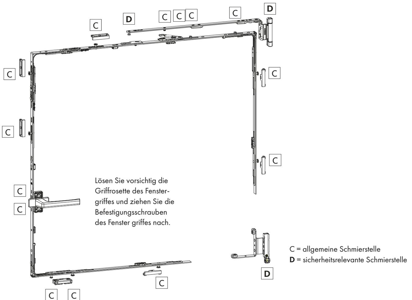
Die dargestellte Beschlagübersicht zeigt die Anordnung der möglichen Schmierstellen und entspricht nicht zwingend dem tatsächlich eingebauten Beschlag. Die Anzahl der Schmierstellen variiert je nach Größe und Ausführung des Fensters und der Fenstertür.
